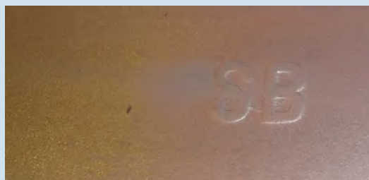
'SB' (Beams and Angles)
